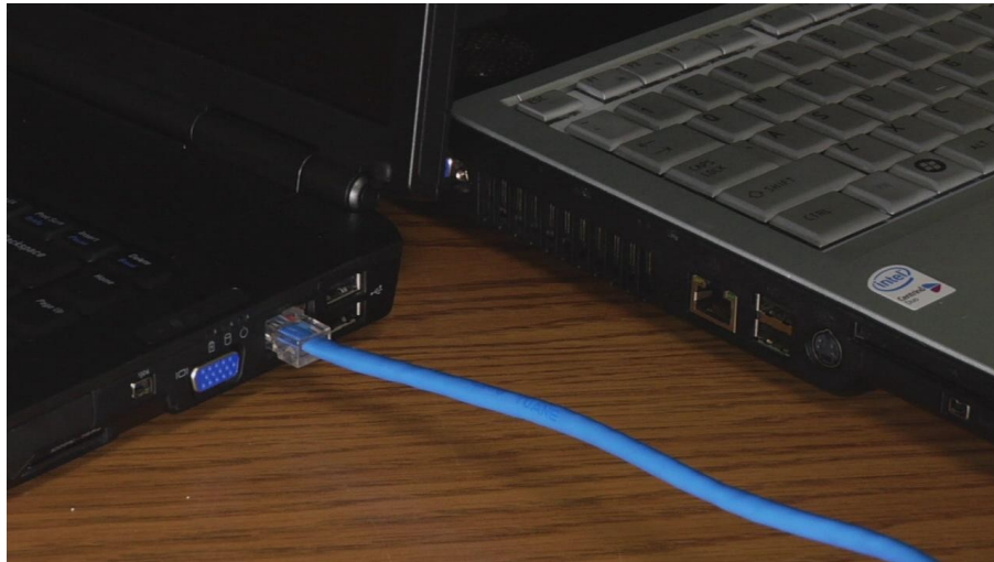
Puerto de red Ethernet
